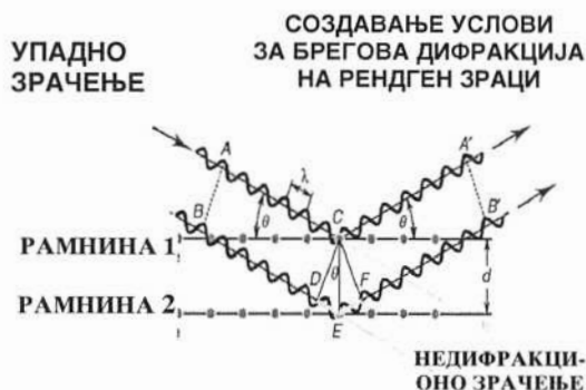
Сл. 2. Шема за создавање услови на рендген дифракција
