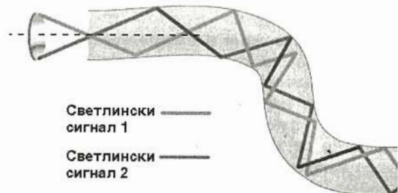
Сл. 15. Простирање на светлина низ оптичко влакно со помош на тотална рефракција
